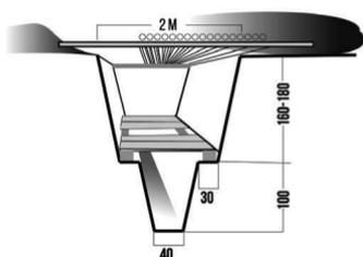
Рис. 4. Отхожее место в траншее, оборудованное поддоном
