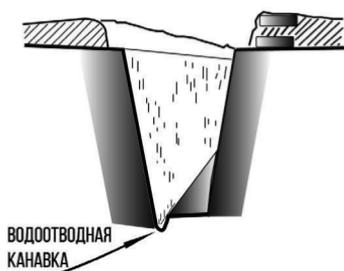
Рис. 2. Водоотводная канавка на дне траншеи
