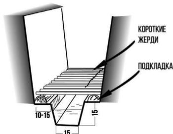
Рис. 3. Перекрытая водоотводная канава на дне траншеи
